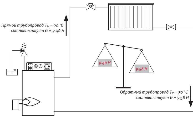
Движение воды вверх, а затем вниз осуществляется за счет разности плотностей теплой и остывшей воды.
