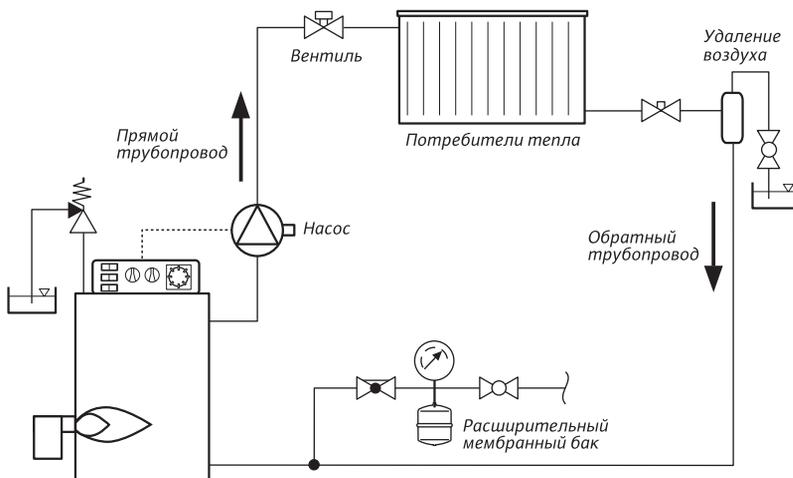
Для того, чтобы уменьшить потребление электроэнергии, необходимо, чтобы моторы насосов с мокрым ротором постоянно меняли частоту вращения. Частоту вращения можно менять вручную с помощью переключателей. Возможна также организация системы автоматики путем установки коммутационной аппаратуры и устройств управления, которые будут срабатывать в зависимости от времени, разности давлений или температуры.
