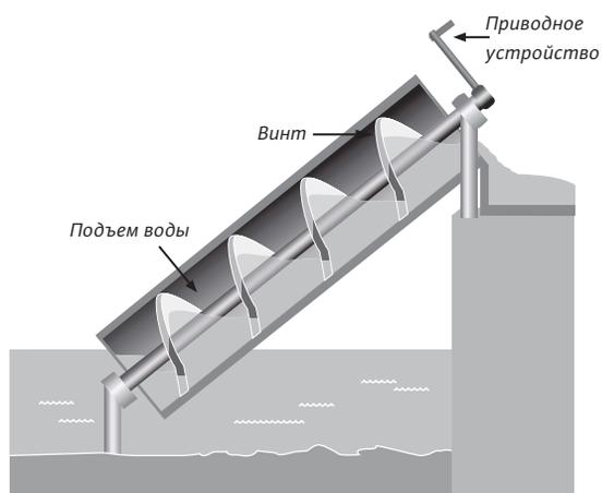
При этом принцип работы механизма был очень похож на тот, по которому работают современные центробежные насосы. Характеристика насоса имеет аналогичную зависимость между напором и подачей. Из исторических источников мы знаем, что такие винтовые насосы работали при углах наклона от  $37^\circ$  до  $45^\circ$ . Они обеспечивали подъем воды на высоту от 2 до 6 м и имели максимальную подачу около  $10 \text{ м}^3/\text{ч}$ .
