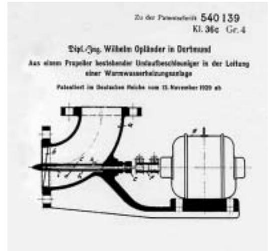
Колесо насоса в форме пропеллера было установлено в изгибе трубы. Оно приводилось в движение уплотняемым валом, который, в свою очередь, вращался двигателем.
