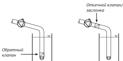
Установка с обратным клапаном или отсечным клапаном/заслонкой
