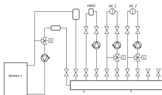
Насосы для системы подогрева воды (WWB) и нагревательных контуров HC 1 и HC 2 работают независимо друг от друга. Циркуляционные насосы предназначены только для преодоления возникающих в системе сопротивлений. Каждый из этих трех насосов последовательно подключен к циркуляционному насосу котла (КР). В задачи последнего входит преодоление сопротивления, возникающего уже в контуре котла.
