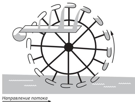
Оригинальное усовершенствование данного устройства было сделано в 1724 г. Джакобом Леопольдом (1674–1727), который присоединил к колесу изогнутые трубы. При повороте колеса вода двигалась к его оси. Течение воды в реке, в свою очередь, служило приводом для этой подъемной установки. Особого внимания в этой конструкции заслуживала форма труб. Она поразительно напоминала форму лопастей современных центробежных насосов.
