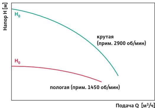
Различная крутизна при идентичном корпусе и рабочем колесе насосов (например, в зависимости от частоты вращения мотора)
