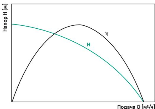
Самый большой общий КПД циркуляционного насоса системы отопления достигается в средней части характеристики насоса. В каталогах производителей насосов эта оптимальная рабочая характеристика указана отдельно для каждого насоса.
