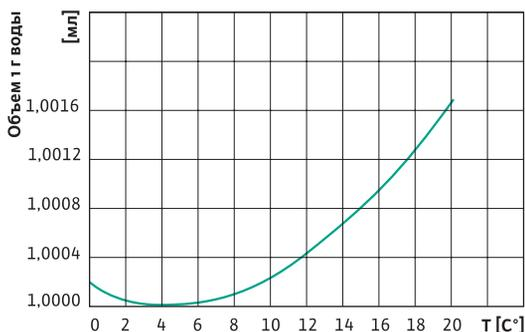
Изменение объема воды при нагреве/охлаждении. Самая большая плотность при 4 °С:  $\rho_{max} = 1000 \text{ кг/м}^3$
