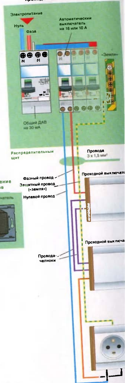
Розетка, управляемая двумя проходными выключателями
