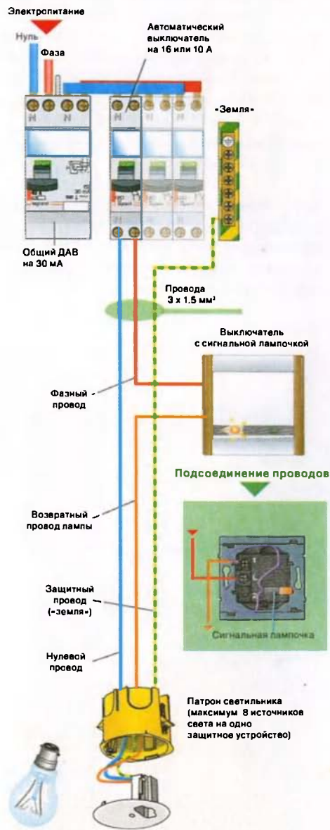
1 Сигнальная лампочка горит, когда светильник погашен
