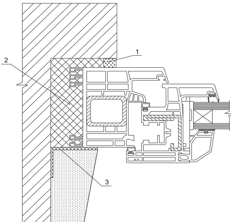
1 — наружный водоизоляционный паропроницаемый слой;
