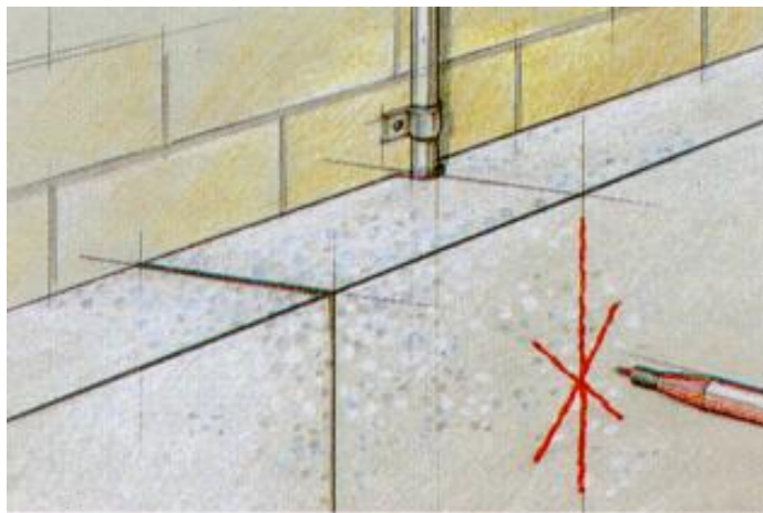
Рисунок 23 – Устройство разметки в местах прокладки инженерных сетей
