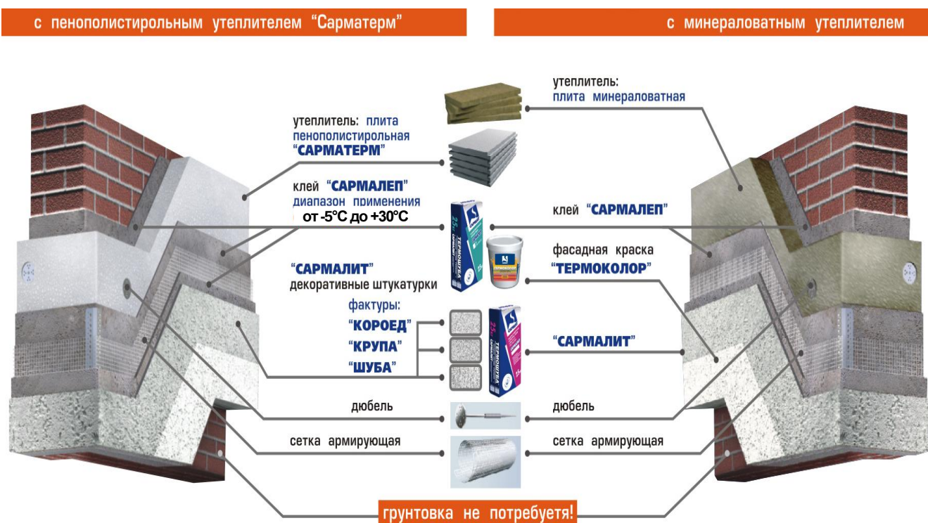
Рисунок 1 – Легкая штукатурная система утепления наружных стен зданий
