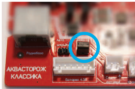
Максимальная чувствительность - перемычка установлена
