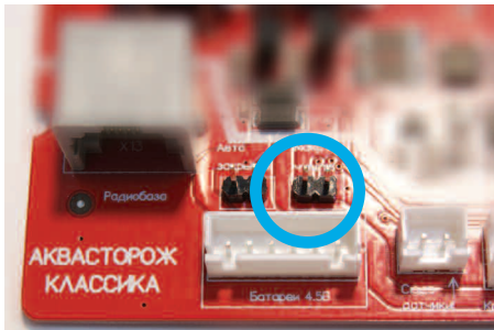
Минимальная чувствительность - перемычка удалена
