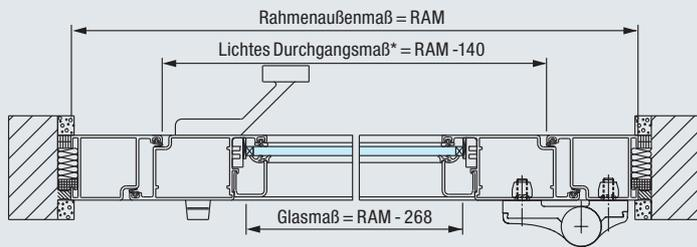
\*Die lichte Durchgangsbreite bei Öffnungswinkel von 90° ohne Berücksichtigung von Griffen und Drückern verringert sich um weitere 44 mm, bei 2-flügeligen Türen um 88 mm.
