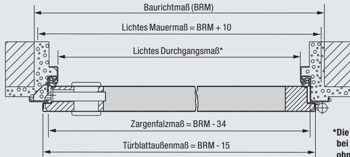
\*Die lichte Durchgangsbreite bei Öffnungswinkel von 90° ohne Berücksichtigung von Griffen und Drückern verringert sich um 2 mm, bei der 2-flügeligen Tür um 4 mm.
