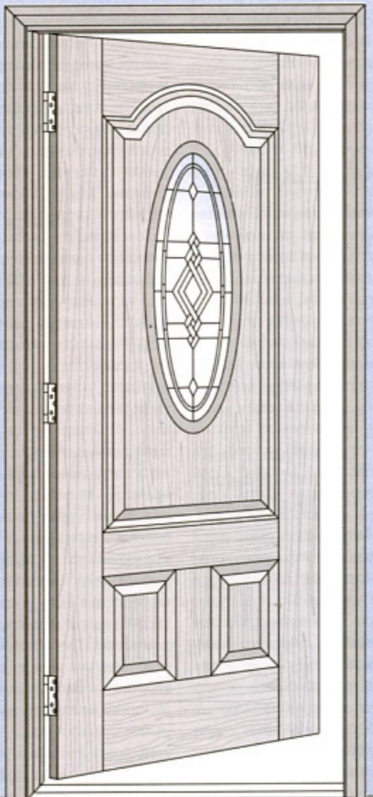
Современная дверь выглядит как деревянная, однако на самом деле сделана из стекловолокна, окрашенного под дерево. Полиуретановая сердцевина обеспечивает хорошую теплоизоляцию; качественные уплотнительные детали препятствуют проникновению воздуха и влаги.
