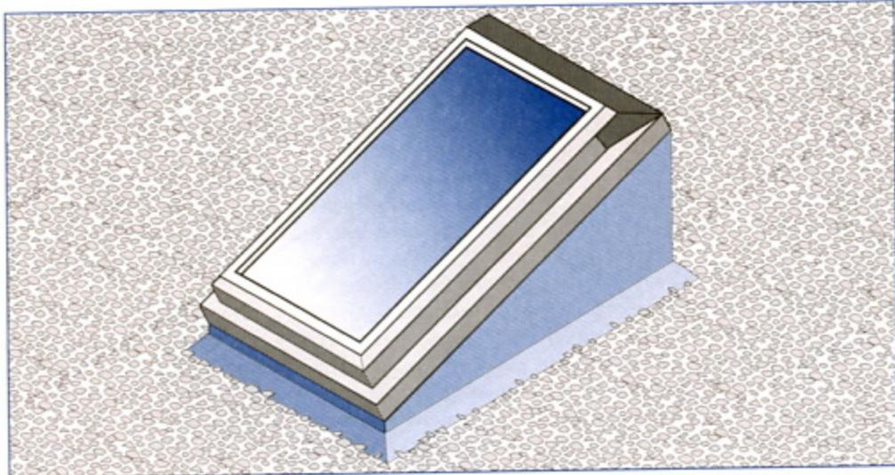
Такой монтажный короб необходим при установке на крыше светового люка, окна типа «фонарь», если наклон ската менее  $15^\circ$  (уклон менее 1:4).
