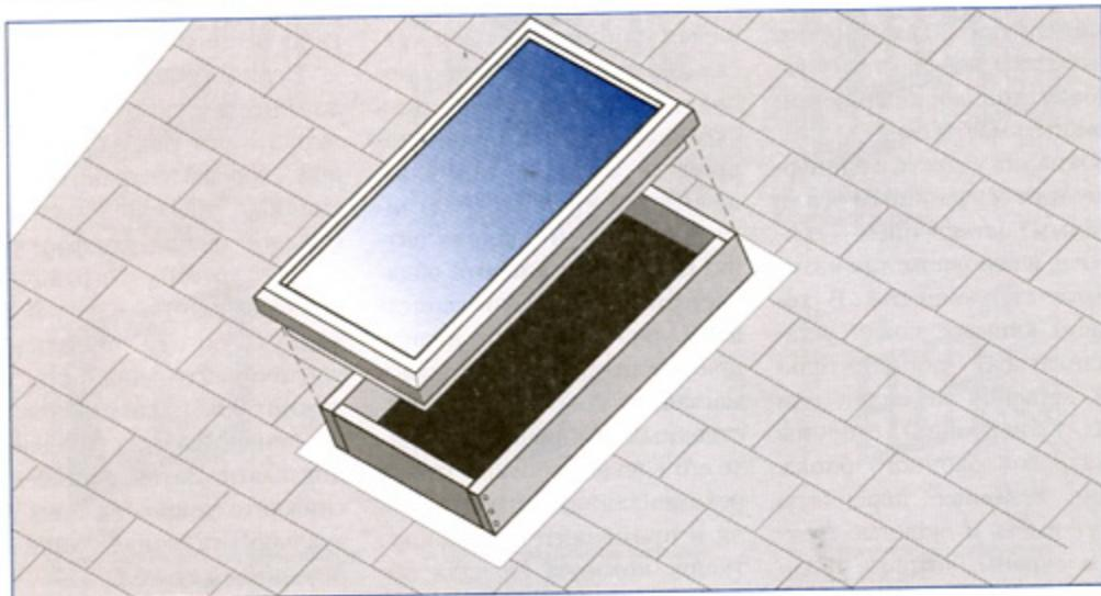
В местности с высоким снежным покровом короб можно сделать самостоятельно из досок 50×100 мм или больше, с тем чтобы приподнять световой люк над поверхностью крыши.
