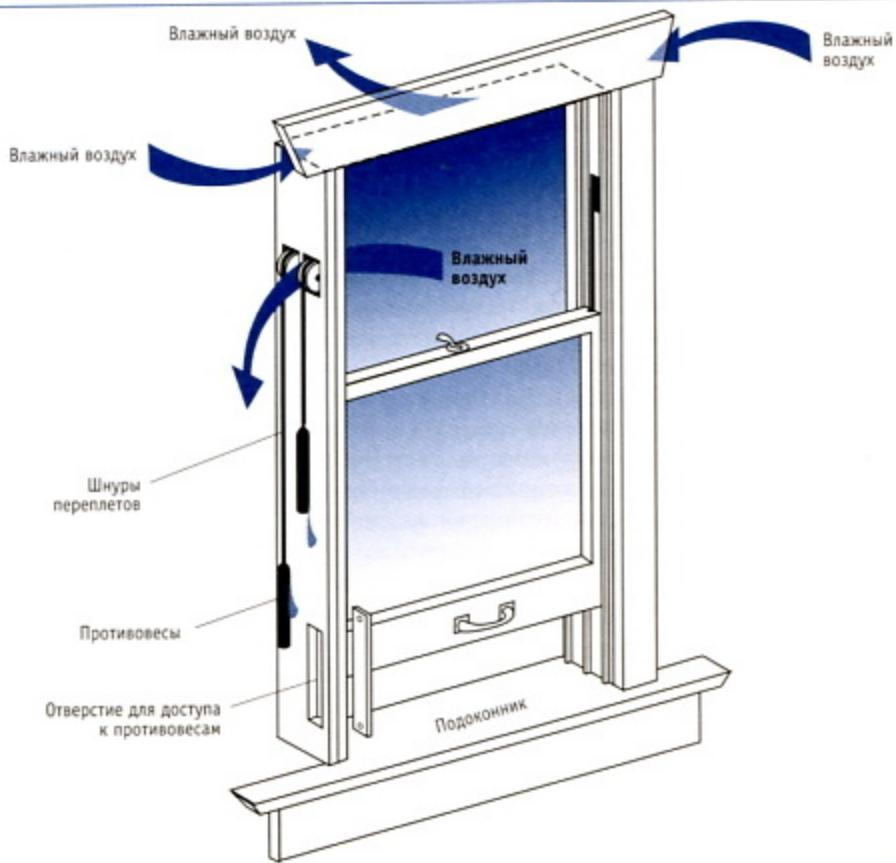
Старые окна с подъемными переплетами можно модернизировать. Снимите противовесы и шнуры, загерметизируйте карманы для противовесов и установите пружинные держатели для фиксации переплета на месте.
