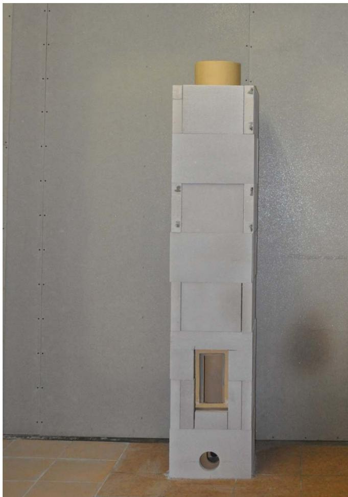
17. В качестве внешней оболочки конструкции для удаления дымовых газов могут быть использованы самые разные негорючие строительные материалы, например, бетонные или газобетонные блоки (представлены на рисунке), плиты, кирпич (снимок на следующем слайде), соединяемые друг с другом на строительном растворе или специальной смеси, рекомендованной производителем.
