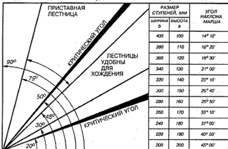
Рис. 3. Диаграмма соотношения между размерами ступеней и углом наклона марша.
