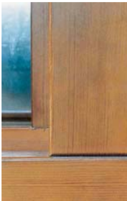
Слева - обработанная пропиткой древесина, справа - необработанная пропиткой древесина
