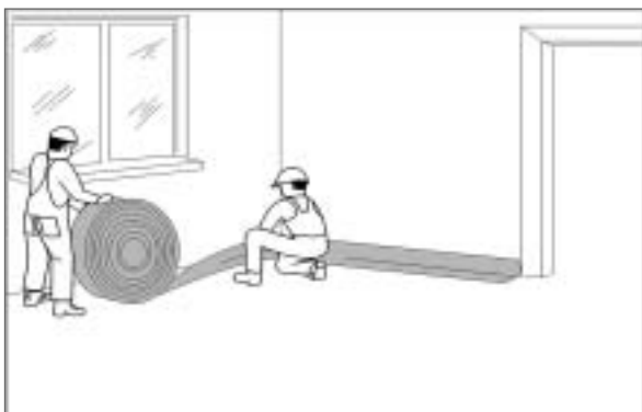
Рис.140. Разложить под стеной изоляционную краевую ленту.
