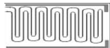
Рис. 137а. Спиральный контур в форме меандра применяется в случае длинных и узких полов с многочисленными разделительными швами.
