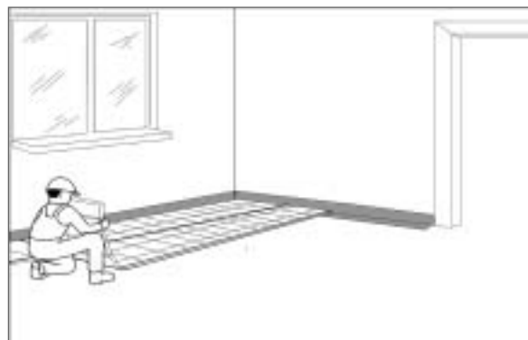
Рис.141. Разложить пенополистирол с верхним слоем из ПЕ.
