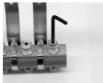
Рис. 154b. Способ выполнения предварительной настройки на запорно-регулирующем вентиле, вмонтированном на обратном коллекторе распределителя.
