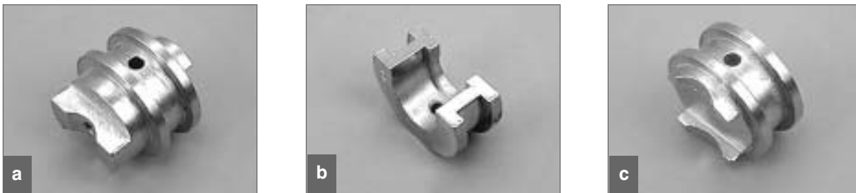
Рис. 28. Вкладыши для прессы: а) фасонный для латунных тройников, б) простой для кольца и латунных фасонных изделий, имеющих фланцы с отступом, с) фасонный для тройников и отводов фиксируемых.
