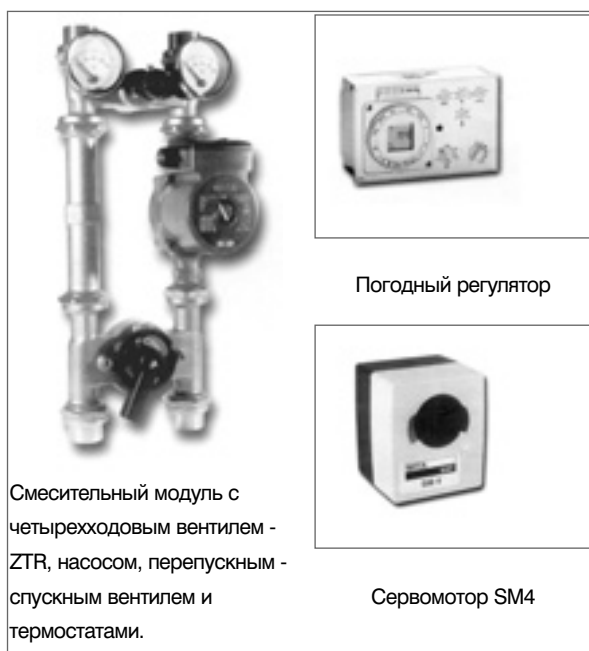
Рис. 149. Смесительный модуль для подпольного отопления, оснащенный сервомотором SM4, подсоединен к погодному регулятору, реализует автоматическое регулирование.
