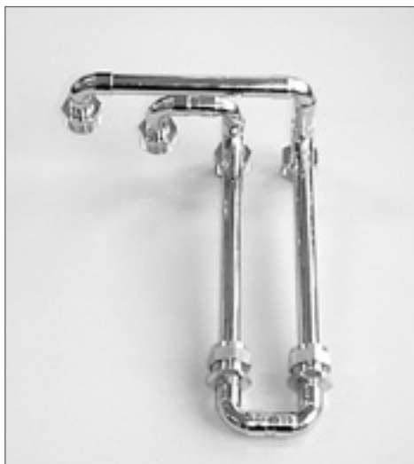
Рис. 89. Комплект для испытаний на давление.
