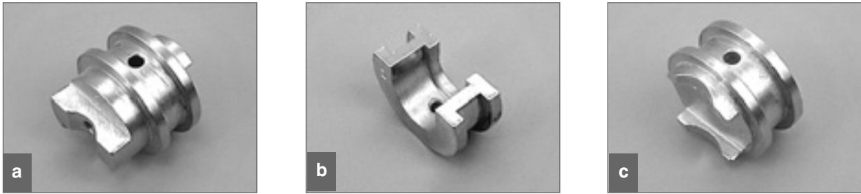
Рис. 28. Вкладыши для пресса: а) фасонный для латунных тройников, б) простой для кольца и латунных фасонных изделий, имеющих фланцы с отступом, с) фасонный для тройников и отводов фиксируемых.
