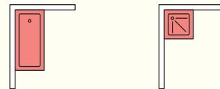
**Зона 0** — пространство внутри самой ванны. В нем допускается эксплуатация приборов, предназначенных для использования под водой (IPX8 и IPX7), с напряжением питания до 12 В. Причем блок питания размещают за его пределами.
