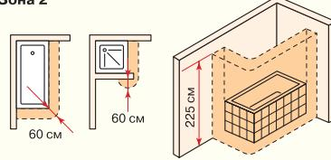
**Зона 2** — область вокруг первой, шириной 60 см. В ней, кроме водонагревателей, «законны» светильники класса защиты II (приборы с двойной изоляцией,
