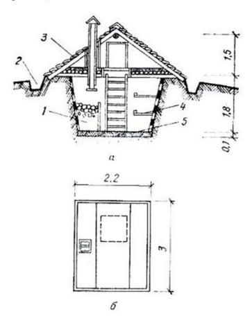
Рис. 10 Земляной погреб: а- разрез; б- план; 1- закром для картофеля; 2- водоотвадная канава; 3- скат; 4- полки; 5- глинобитный пол
