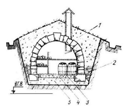
Р и с. 7. Каменный погреб, сооруженный при низком уровне грунтовых вод: 1 — засыпка грунтом; 2 — глиняным замок; 3 — цементная стяжка; 4 — бетон; 5 — щебень
