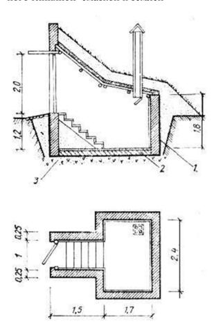
Рис 8. Каменный погреб из красного кирпича: 1- обмазка и проливка основания горючим битумом; 2- бетон; 3- утрамбованный щебнем грунт
