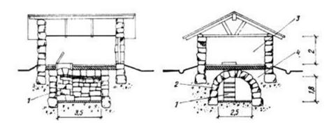
Рис.6 Каменный погреб с каменной погребицей: 1- ступени лестници; 2 - каменный свод; 3- погребица; 4- пазуха забитая утрамбованной глиной
