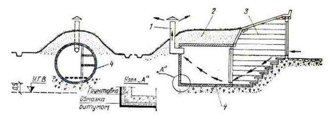
Рис. 13. Погреб из железобетонных колец: 1 — вытяжка; 2 — обваловка грунтом; 3 — входной тамбур; 4 — бетонные кольца
