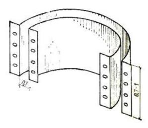
Рис. 14 Скользящая опалубка из кровельного железа
