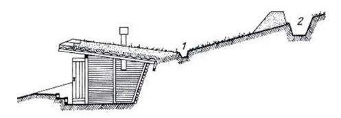
Рис. 11. Погреб на косогоре: 1 -водоотводная канава; 2 — нагорная канава
