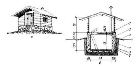
Рис. 9 Погреб с погребицей: а- общий вид; б- разрез ; 1- утеплитель; 2- известковая побелка; 3- отмостка; 4- обмазка горячим битумом; 5- глиняный замок; 6- бутобетон
