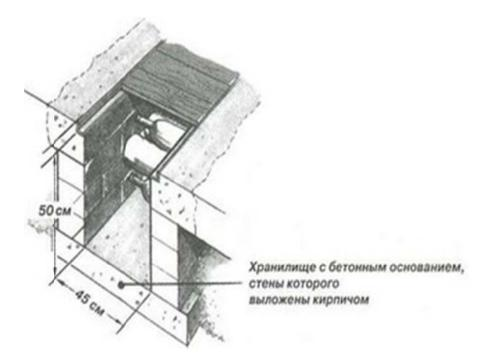
Общая длина стен траншеи, которые выкладывают кирпичом,— порядка трех метров. Бетонное основание должно быть толщиной не менее 8 см. Готовые стенки желательно оштукатурить.
